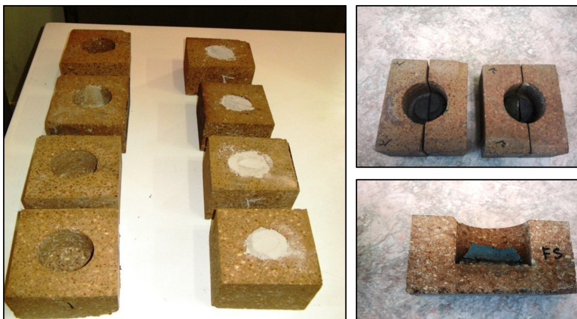
شکل ۱- نمونه های برش خورده آجرهای منیزیا-اسپینلی بکار رفته جهت تست خوردگی
